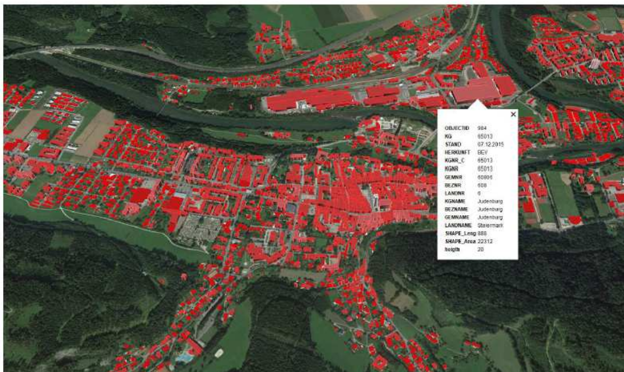
Obrázek 6: Příklad vytvořeného 3D modelu budov v LOD1 v pilotní oblasti Judenburg (Rakousko).
