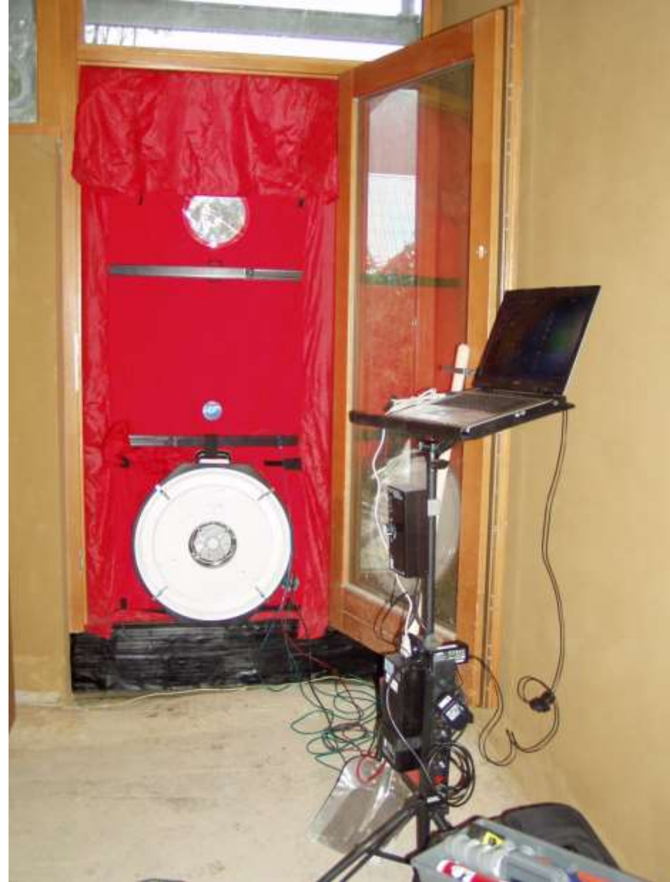
TĚSNĚNÍ PÁSKAMI A MĚŘENÍ VZDUCHOTĚSNOSTI
