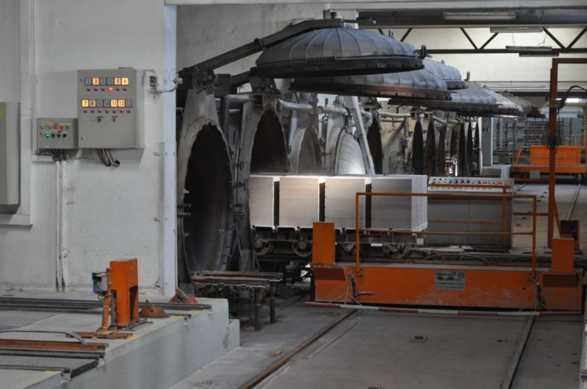
TECHNOLOGIE VÝROBY VÁPENOPÍSKOVÝCH BLOKŮ – MATERIÁL VJÍŽDÍ DO AUTOKLÁVŮ
