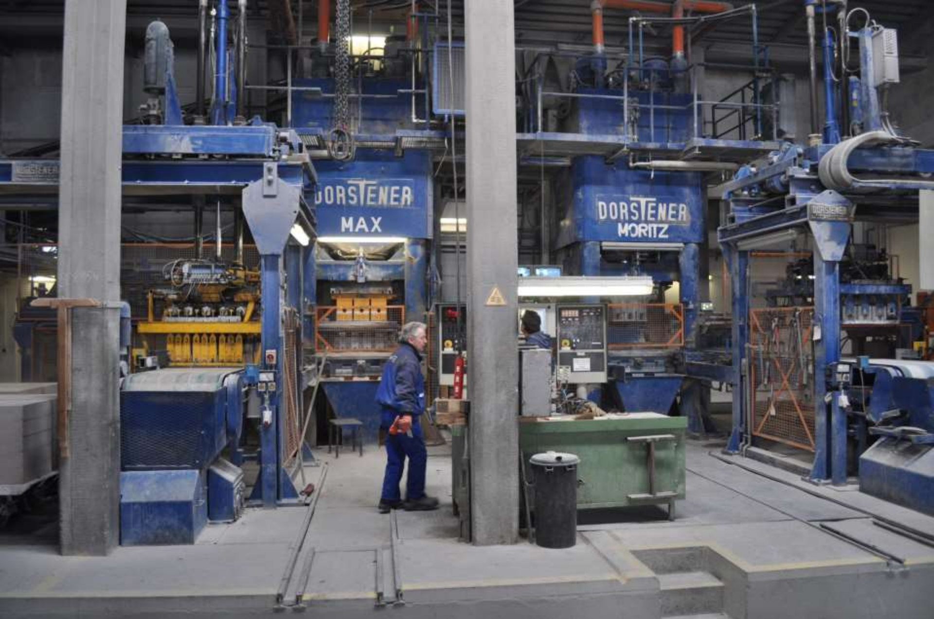
TECHNOLOGIE VÝROBY VÁPENOPÍSKOVÉHO MATERIÁLU – LISOVÁNÍ BLOKŮ
