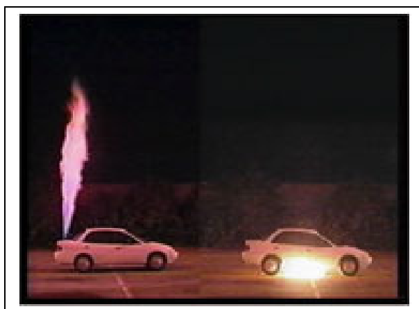
Obr. 23 Test bezpečnosti nádrže na vodík (vlevo) a benzin (vpravo)
