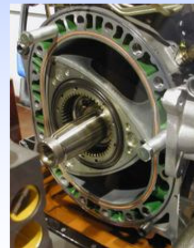
Rotační píst u Wankelova motoru
