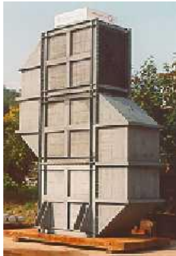
Deskový výměník - sestava
