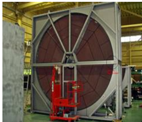
Obr. 86 Princip a reálné provedení rotačního koncentrátoru (15)
