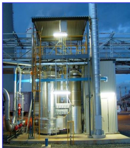
Obr. 83 Spalovací zařízení odplynů s rekuperačním výměníkem v kompaktním provedení (17)
