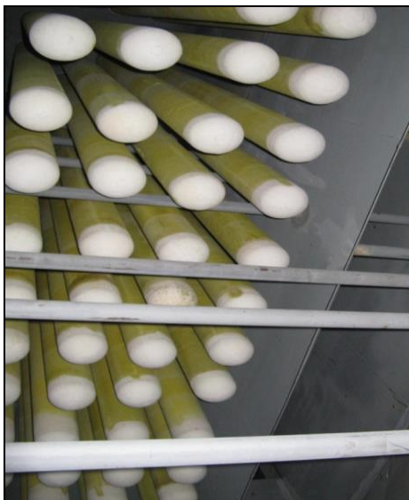
Obr. 114 Keramické filtrační elementy ve filtru (17)
