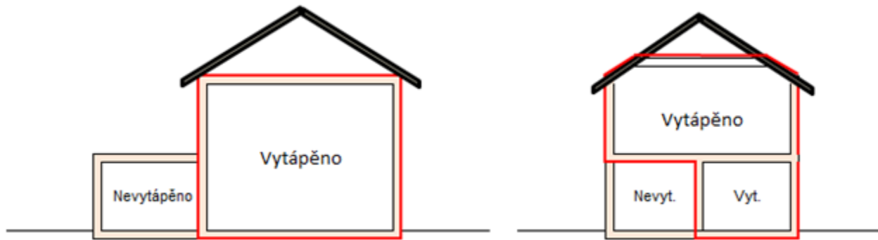
Obr. 6 – Systémová hranice budovy (obálky budovy, resp. vytápěné zóny)
