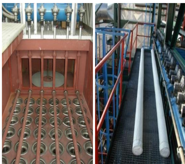
Obr. 108 Filtrační rukávce spolu s horní trubkovnicí (17)
