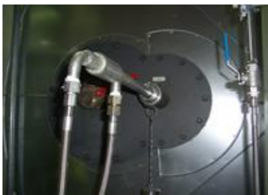
Obr. 62 Rozprašovací tryska (17)
