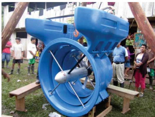
Obrázek 54: SMART 5 kW, vč. instalace. Zdroj: Zdroj [26]
