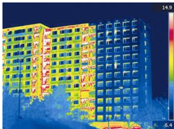
Obr. 5 – Tepelné ztráty budovy v závislosti na zateplení
