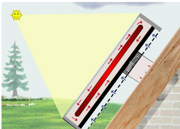
Obrázek 58: Funkce vzduchového kolektoru. Zdroj: Zdroj [28]
