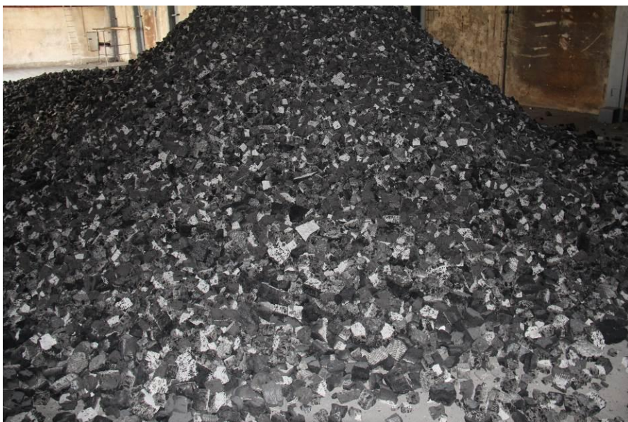
Obrázek 7: Výsledný produkt linka na výrobu pěno-skla ve společnosti A-GLASS RECYCLING – izolace základových desek
